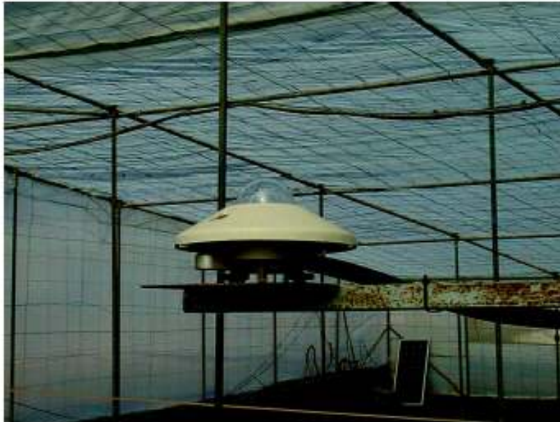
Piranómetro (Radiación solar)
