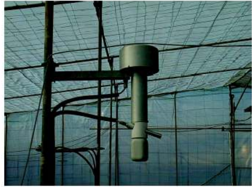
Aspirosicrómetro (temperatura y humedad relativa)
